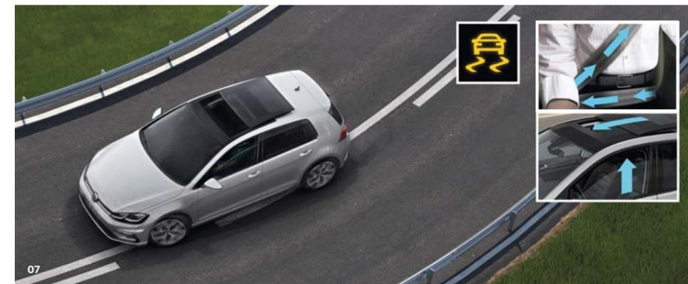
**05** Puede salvar vidas en caso de emergencia: el sistema de asistencia **"Emergency Assist"** detecta la indisposición del conductor y toma el control del vehículo.<sup>1)</sup> Cuando el sistema no detecta ninguna acción sobre el volante, los frenos o el acelerador, toma el control del vehículo manteniéndolo en el carril y reduciendo la velocidad hasta detenerlo. "Emergency Assist" está disponible exclusivamente como parte del paquete de asistencia al conductor. **S**
