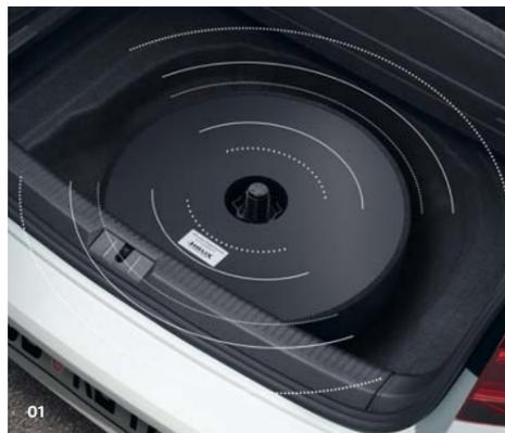
**01** El sistema de sonido "Plug & Play" incorpora un procesador digital de sonido integrado y un potente subwoofer permite disfrutar de la música al más alto nivel. El sistema tiene una potencia total sinusoidal de 300 vatios y musical de 480 vatios en configuraciones de sonido específicas según el vehículo y el conductor. Gracias al sistema "Plug & Play" el subwoofer puede montarse rápidamente en el hueco de la rueda de repuesto o, alternativamente, en el maletero. **O** Ref. 000051419B
