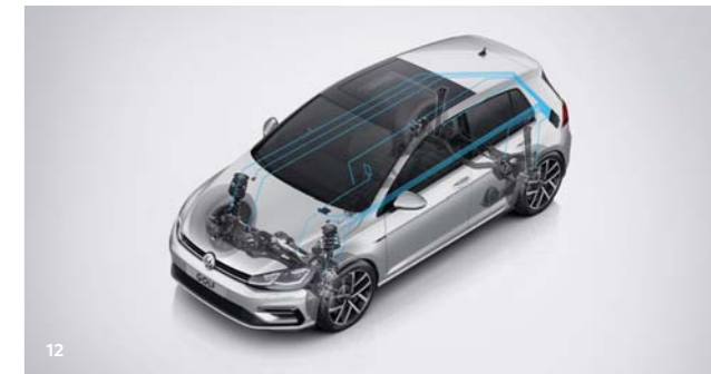
(sin imagen) El asistente de mantenimiento de carril "Lane Assist" detecta si el vehículo se sale del carril a partir de una velocidad de 65 km/h. El sistema ayuda al conductor a mantener el vehículo dentro del carril. 1) O
