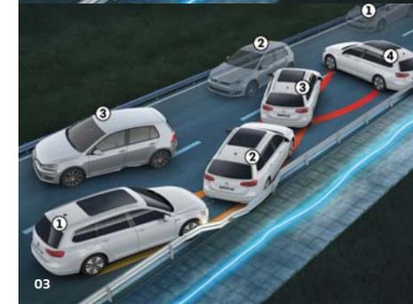
**03** Dentro de los límites del sistema, el **freno anticollisiones múltiples** frena automáticamente el vehículo hasta reducir la velocidad a 10 km/h tras una colisión, en caso de que el conductor no actuara por sí mismo. De este modo pueden prevenirse, o al menos mitigarse, las colisiones secundarias. **S**
