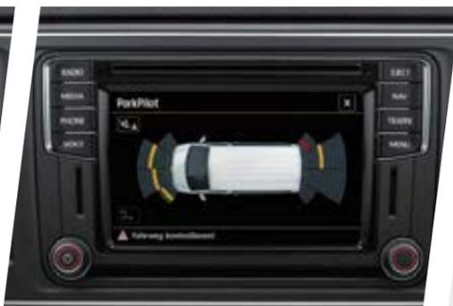
**ParkPilot.**<sup>2)</sup> Señales acústicas que alertan al conductor de la presencia de obstáculos en la parte delantera y trasera del vehículo al aparcar, y también indican la distancia a cualquier obstáculo de manera visual en la pantalla. | BE | OC |
