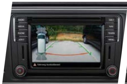
**Rear View (cámara de marcha atrás).** Facilita el estacionamiento mostrando una imagen de la zona posterior del vehículo en la pantalla del sistema de radio<sup>1)</sup> o navegación. | BE | OC |
