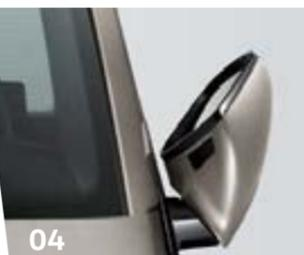
**04 Retrovisores externos plegables eléctricamente.** Los retrovisores externos térmicos y ajustables eléctricamente se incorporan de serie. Opcionalmente, los espejos también tienen una función eléctrica de plegado. Dependiendo del modelo, las carcasas del espejo están pintadas o sin pintar. | BE | OC |
