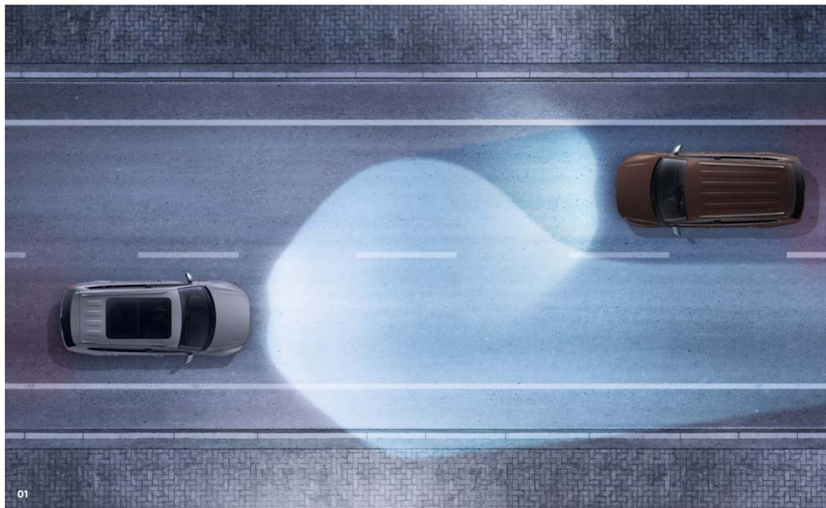
**01** La regulación dinámica de la luz de carretera “Dynamic Light Assist” te permite utilizar las luces de carretera de forma constante a partir de 60 km/h sin deslumbrar a los vehículos que circulan en sentido contrario.<sup>1)</sup> Una cámara detecta los vehículos que circulan delante o a los vehículos que se aproximan y oculta las áreas de luz correspondientes.<sup>1)</sup> **S**
