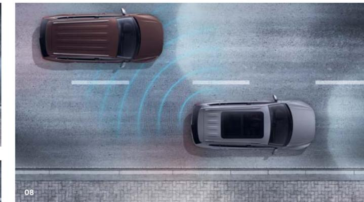
**06** Con el paquete Safety disfruta de un mayor confort, incluso en los atascos. El asistente para atascos permite una conducción cómoda durante los atascos y ayuda a evitar los accidentes típicos que pueden producirse al encontrarse en uno. El sistema mantiene el vehículo en el carril y lo dirige controlando la aceleración y los frenos.<sup>1)</sup> **O**
