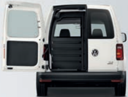
Puerta trasera de dos hojas con apertura de ventanilla dividida asimétricamente (2/5 a 1/5) para Caddy Furgón y Kombi
