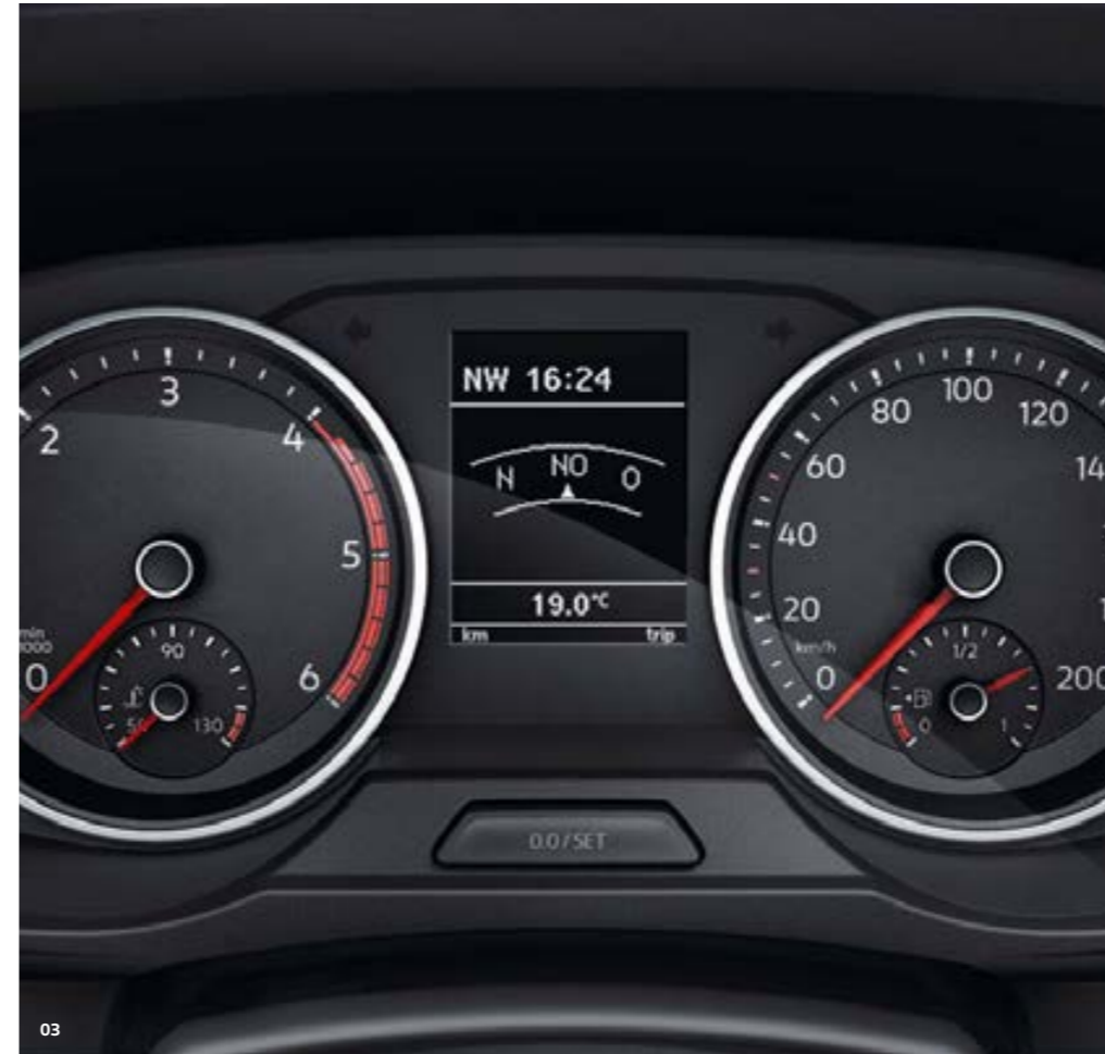
03 Pantalla multifunción "Plus". La pantalla TFT monocroma muestra información actual, como la temperatura exterior, la autonomía restante, la velocidad media y el consumo promedio. Facilita además un uso cómodo de los sistemas de asistencia al conductor y un control rápido de las funciones del vehículo. | FU | CH | CA |
