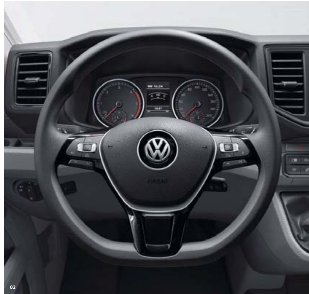
02 Volante Multifunción. La pantalla multifunción, el teléfono móvil con función de manos libres y el sistema de radio y navegación se manejan cómodamente mediante las levas situadas en el volante multifunción. | FU | CH | CA |
